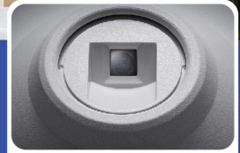
3D Move-eye Human Sensor อุปกรณ์เสริมที่ติดตั้ง (Built in) อยู่ที่บนของหน้ากาก เพื่อช่วยปรับการกระจายอุณหภูมิที่ไม่สม่ำเสมอและลดการสิ้นเปลืองพลังงาน
